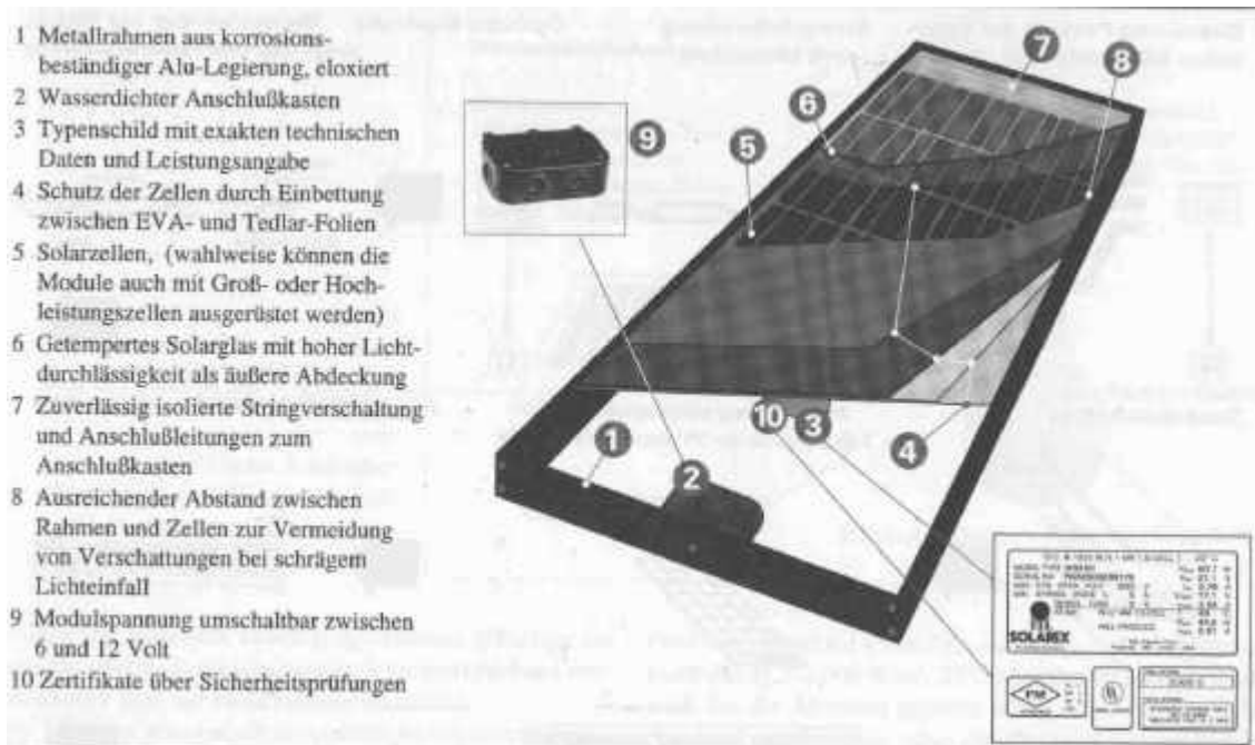
Abb. 4.1 Aufbau eines Solarmoduls (Ladener S. 45, Solartex-Firmenunterlagen)
